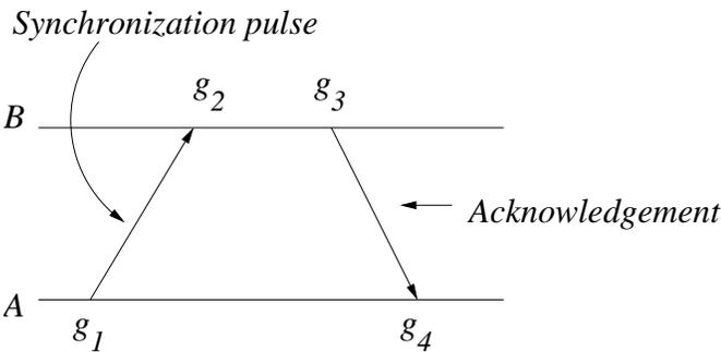
Fig. 18. Two-way message handshake
